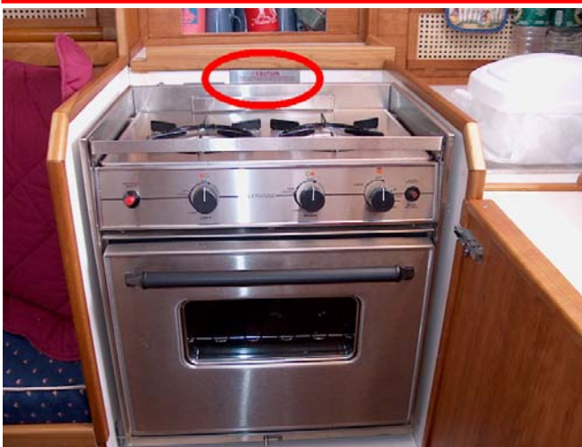
Deze oven met 2 pits gasstel is cardanisch opgehangen. Daarom is hier een slangaansluiting op zijn plaats.
