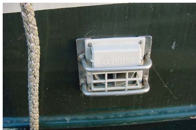
Een voorbeeld van een gecombineerde luchtaanvoer en verbrandingsgas afvoer. De afstand tussen de uitlaat en de dichtstbijzijnde raam wat open kan hoort groter dan 500 mm te zijn.
