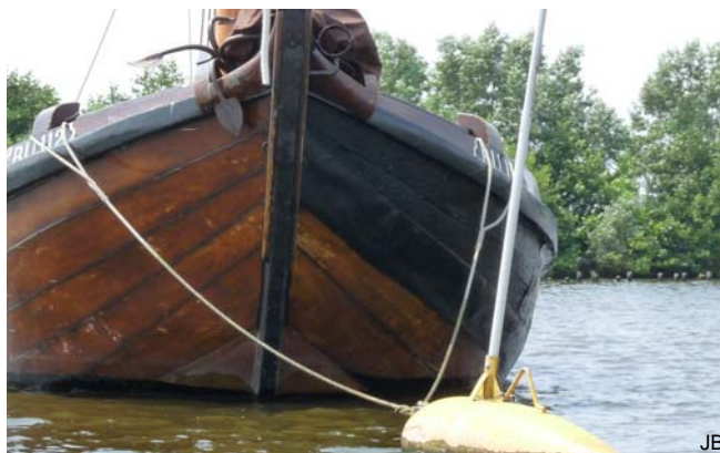
Dubbelplaat op een houten schip (doodskleed).
