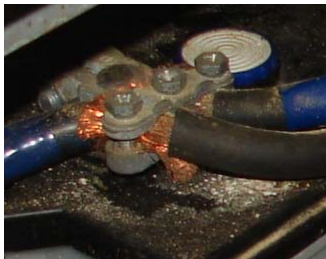
Constructie is niet geïsoleerd, kabels zijn slecht gemonteerd en de accu kan schuiven en is vies...
