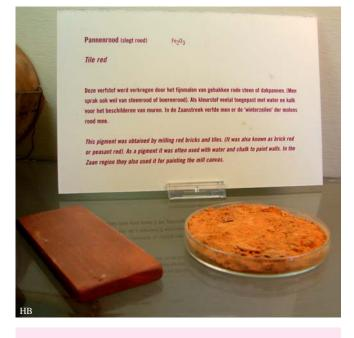
Pannenrood (slegt rood) Fe2O3 Tile red (Dutch) Deze verfstof werd verkregen door het fijnmalen van gebakken rode steen of dakpannen. (Men sprak ook wel van steenrood of boerenrood). Als kleurstof veelal toegepast met water en kalk voor het beschilderen van muren. In de Zaanstreek verfde men er de 'winterzeilen' der molens rood mee.
