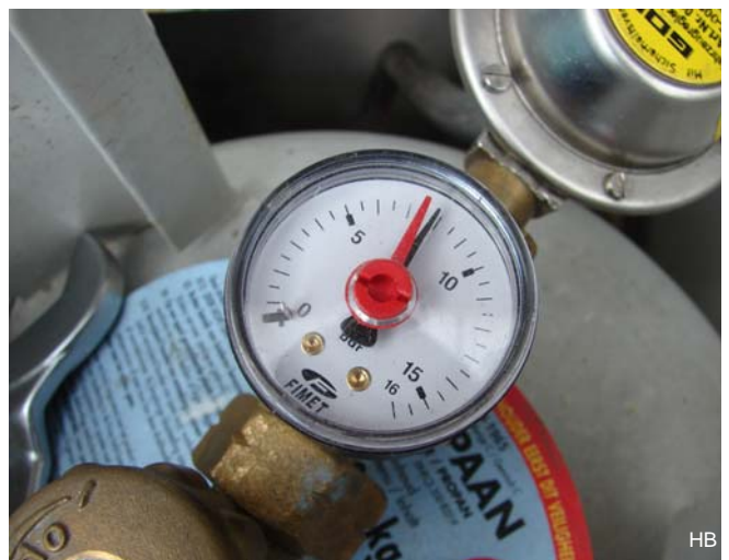
Na 5 minuten wijst de manometer nog 7,9 bar aan. Een goede reden om eens op onderzoek uit te gaan en een ander af te soppen.
